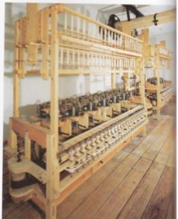
1769 patentiert, 1996 wieder in Betrieb: Die Feinspinmaschine Water Frame, die feines Baumwollgarn kontinu- ierlich spinn
